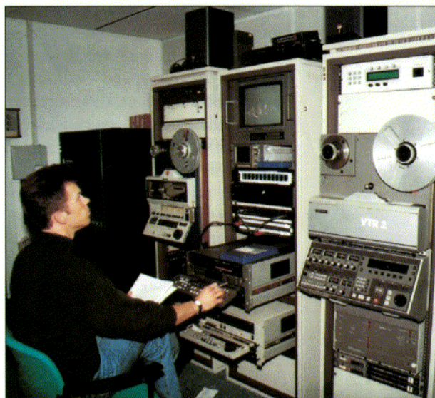
Een film op Betacam-tape wordt door de grijper, de 'grabber', beeldje voor beeldje van de band getrokken. Het beeld loopt en gaat weer terug. Zo wordt het geheugen gevuld. Supervising Encoder Engineer Gerhard Nevenzal volgt het proces kritisch.
